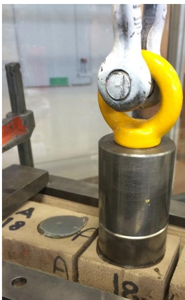
Foto 4. Aftrækstest af mindre areal med med runde ståklodser.
