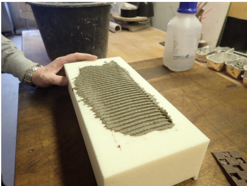
Foto 1. Påført lim med tandspartel 3mm.
