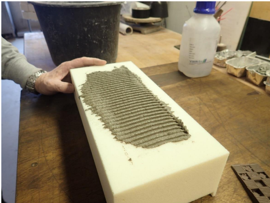
Foto 1. Påført lim med tandspartel 3mm.
