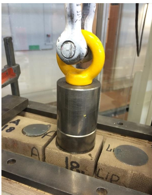
Foto 4. Aftrækstest af mindre areal med med runde ståklodser.
