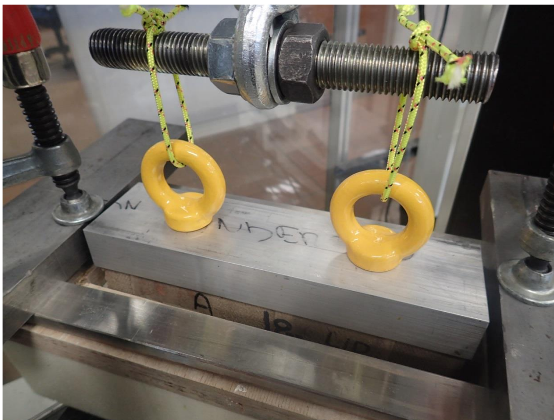
Foto 3. Aftrækstest med aluminiumsklodser.
