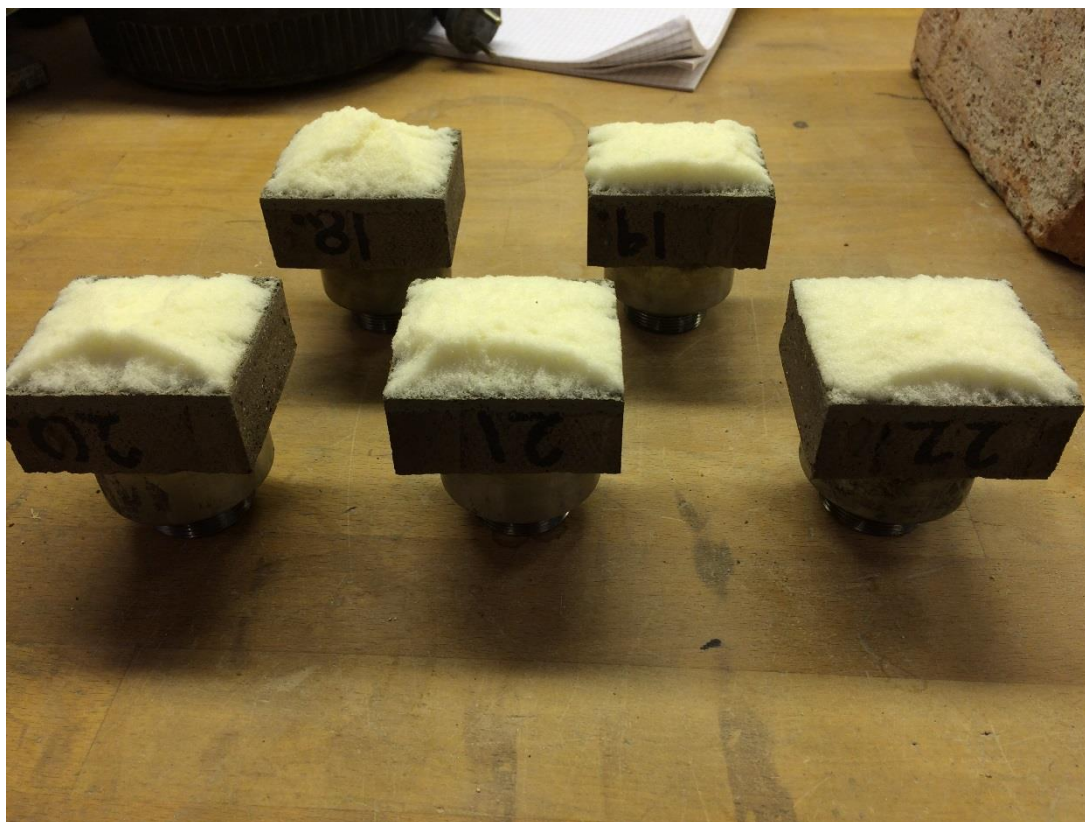
Foto 5. Brudform af PIR-isolering efter aftrækstest.
