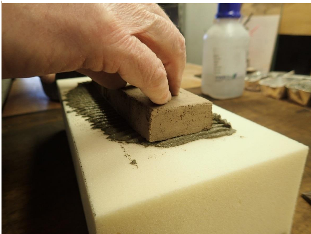
Foto 1. Påført lim med tandspartel 3mm.
